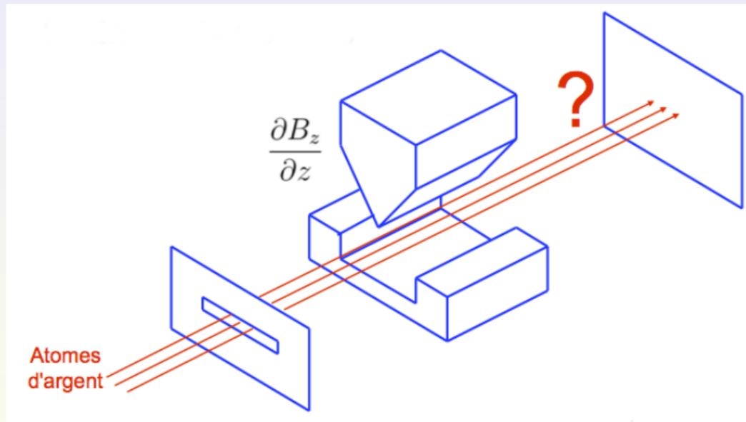
Figure 1 : Dispositif expérimental de Stern & Gerlach
